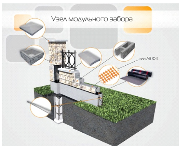
Рисунок 3 – пример забора с использованием камней КСК 15.39.39.14 (колонны), КСК 16.39.19.14 (пролеты) и накрывных элементов ПН 1-1 (колонны), ПН 2-1 (пролеты)
