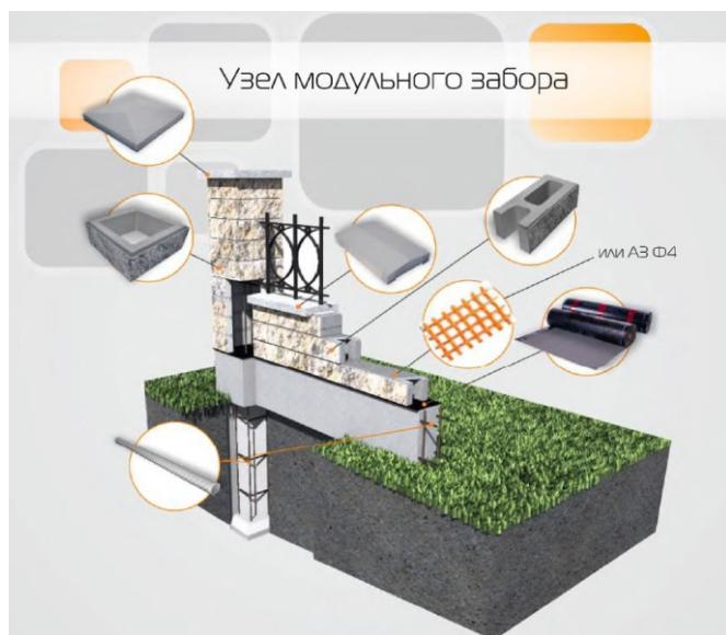
Рисунок 3 – пример забора с использованием камней КСК 15.39.39.14 (колонны), КСК 16.39.19.14 (пролеты) и накрывных элементов ПН 1-1 (колонны), ПН 2-1 (пролеты)
