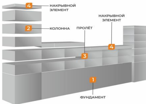
Рисунок 2 – пример забора с использованием камней СКЦт-1Л-100 (колонны и пролеты) и накрывных элементов ПН 2-1 (колонны и пролеты).
