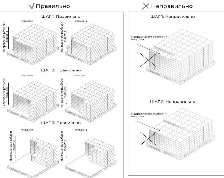
Рисунок 1 – схемы разбора поддонов с тротуарными плитами
